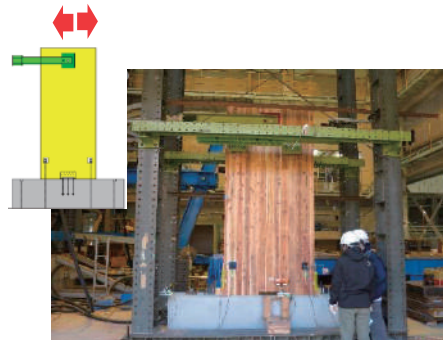
脚部①水平加力試験の試験風景
