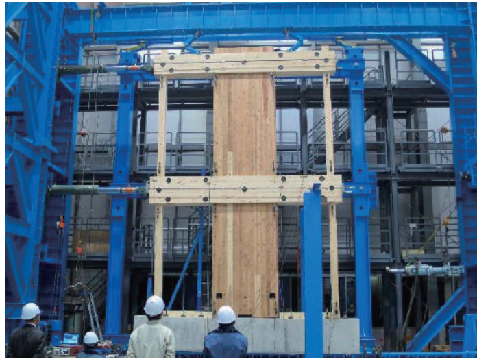
2 層の水平加力試験の試験風景
